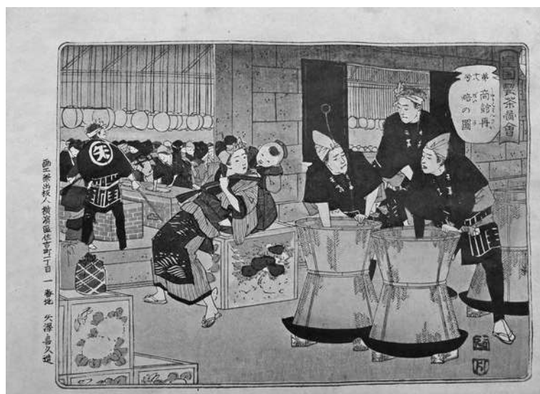
図 1-1 横浜居留地の茶再製場（建物の奥が茶再製場の内部、手前左に積んであるのが茶葉を梱包する木箱、右側はバスケット・ファイヤリングと呼ばれた乾燥方法）（神奈川県立図書館所蔵、望齋秀月『皇国製茶図絵』1885年刊のうち、「第十八号 商館再焙の図」）
